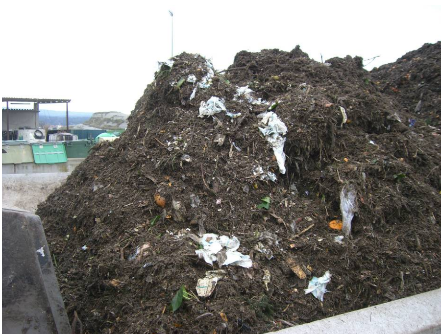
Figura 7. Módulo de descomposición (FORM con pañales triturados)
