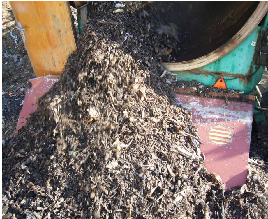
Imagen 16. Material reciclado procedente del cribado de la pila sin pañales
