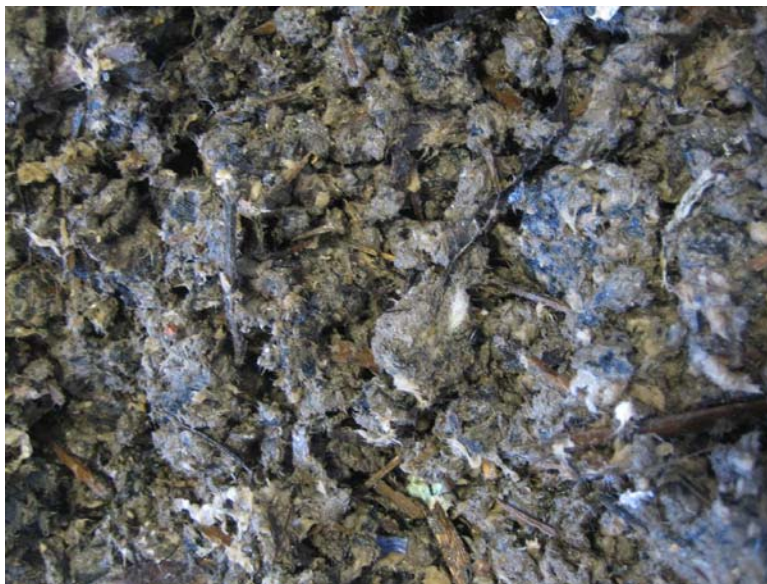
Figura 9. Imágenes del material final (lodos de depuradora con pañales)
