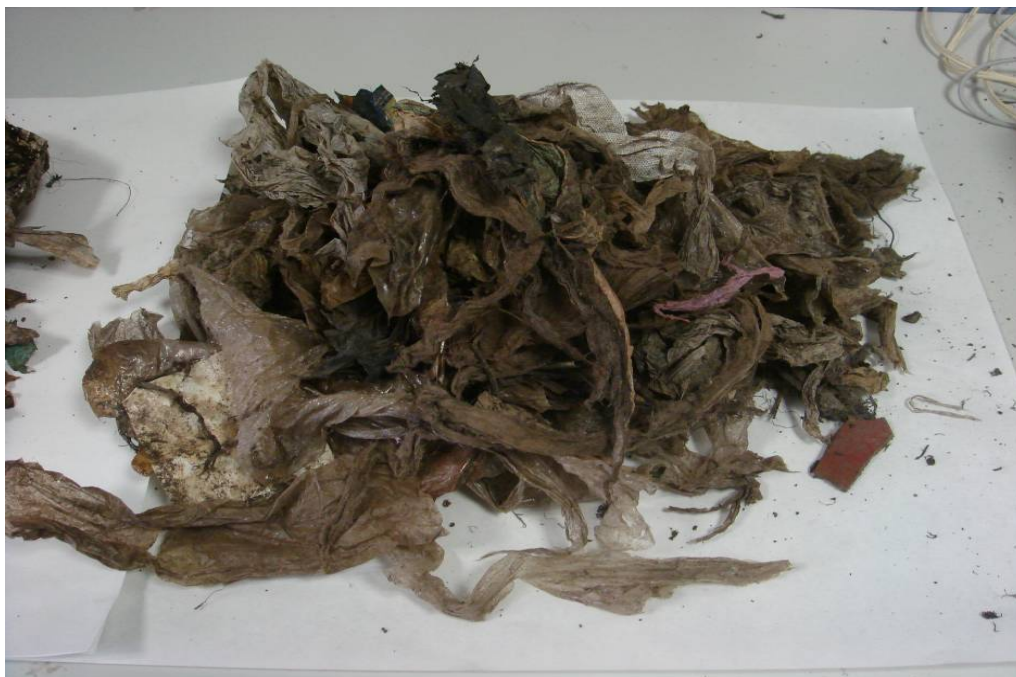
Imagen 18. Detalle del rechazo del material reciclado procedente del cribado de la pila con pañales
