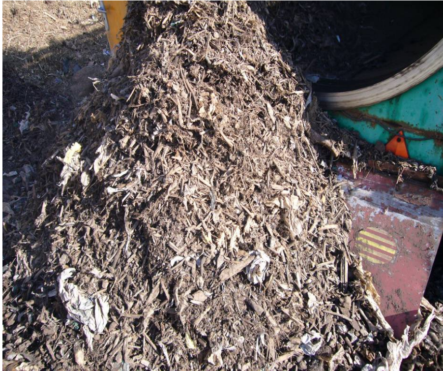
Imagen 15. Material reciclado procedente del cribado de la pila con pañales
