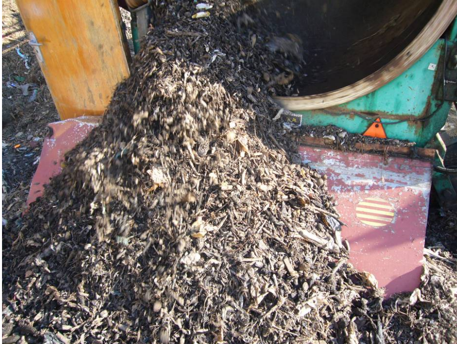
Figura 14. Detalle del rechazo del material recirculado procedente del cribado de la pila sin pañales
