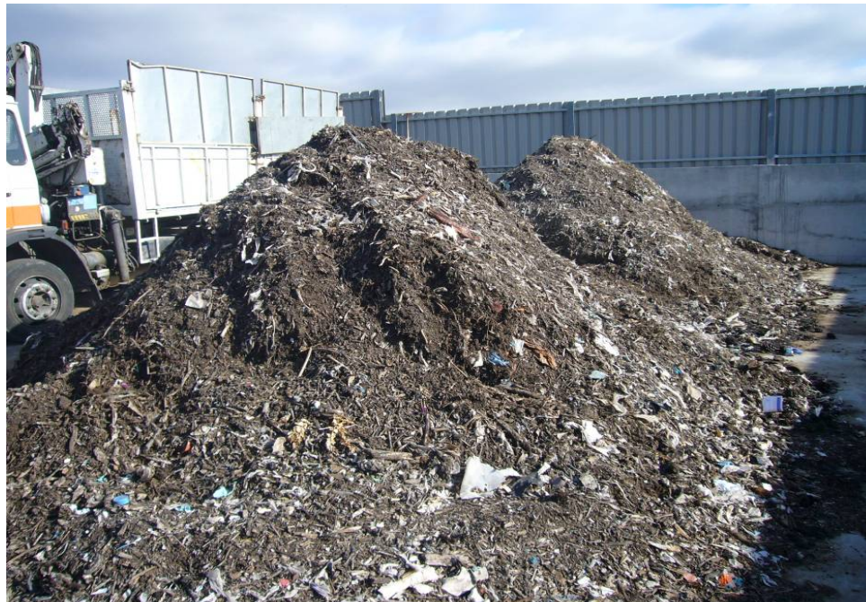
Imagen 11. Imagen de las dos pilas en la parte final del proceso (delante con pañales, detrás sin pañales)
