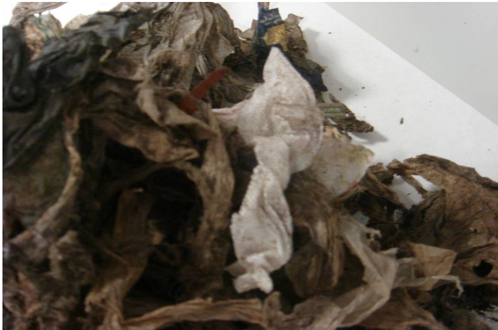
Imagen 19. Detalle del rechazo del material reciclado procedente del cribado de la pila con pañales
