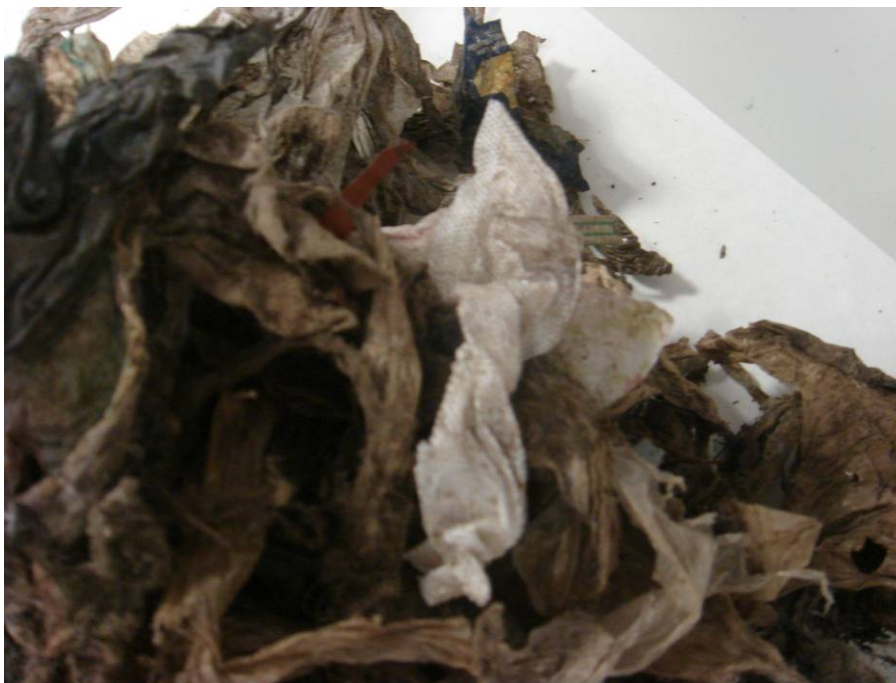
Figura 16. Detalle del rechazo del material reciclado procedente del cribado de la pila con pañales
