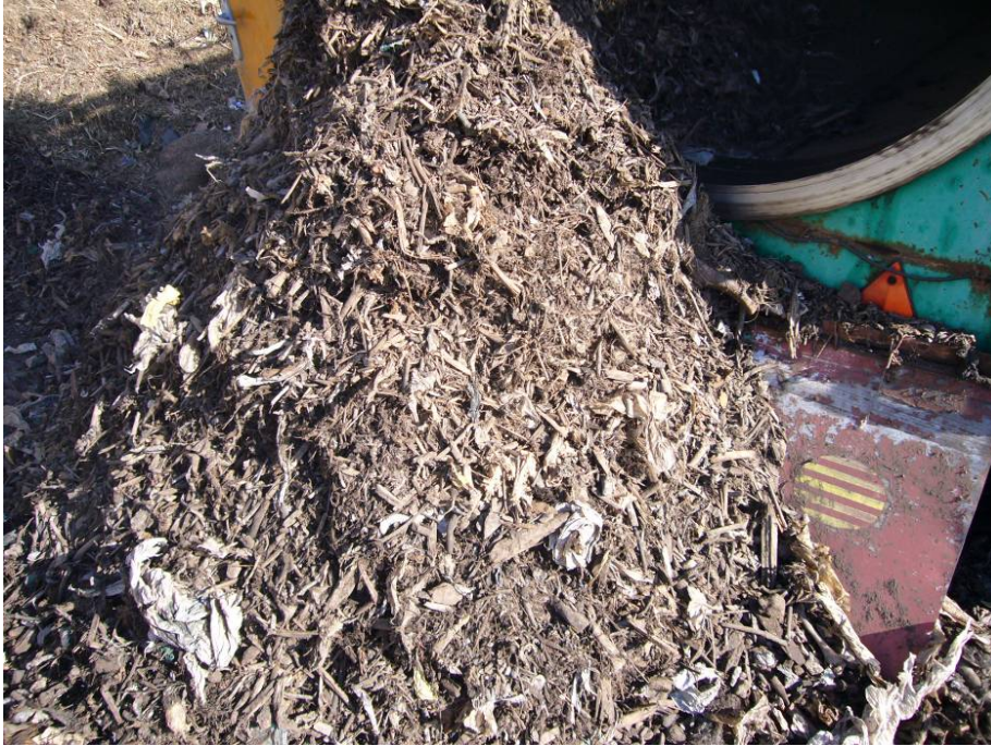
Figura 12. Material reciclado procedente del cribado de la pila con pañales
