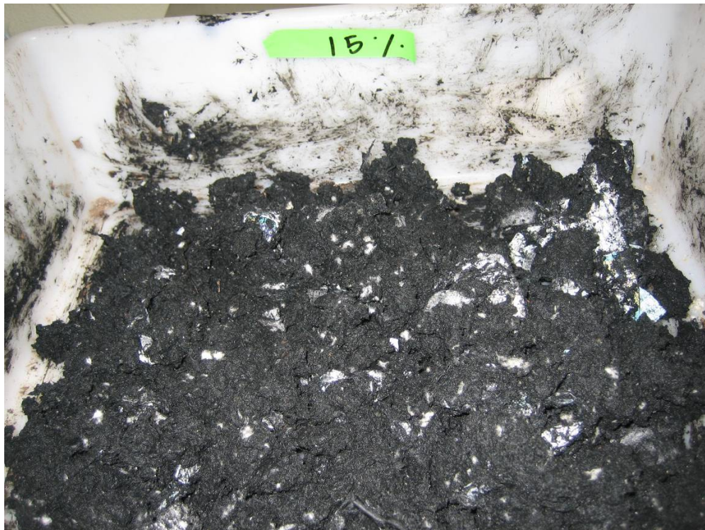
Imagen 5: Detalle de la mezcla inicial de lodos con un 15% de pañales
