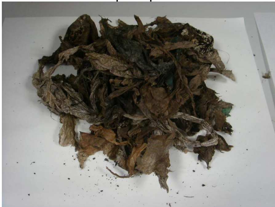
Figura 14. Detalle del rechazo del material recirculado procedente del cribado de la pila sin pañales
