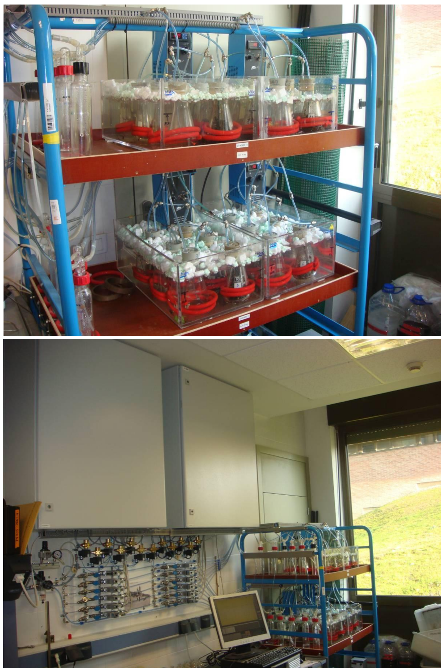
Imatge 1: Respiròmetre dinàmic utilitzat en les proves.
