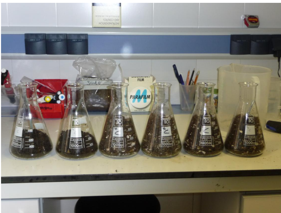
Imatge 2: Mescles de compost amb bolquers. A dalt: mescla estàndard. A baix: d'esquerra a dreta: duplicat de control de compost sol (2 mostres) i la resta són els duplicats amb bolquers biodegradables de les dues marques.
