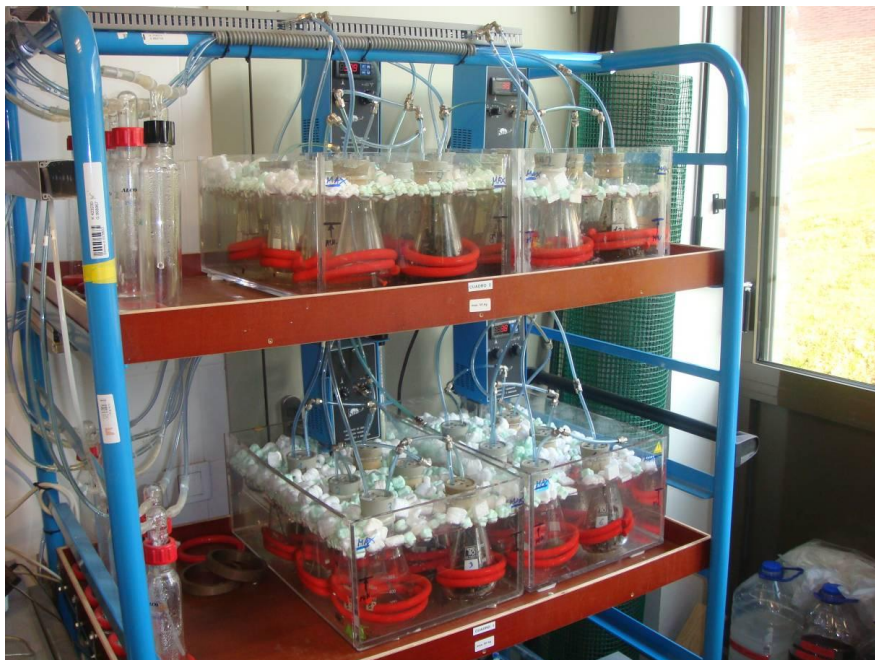
Figura 1. Respiròmetre dinàmic utilitzat en les proves
