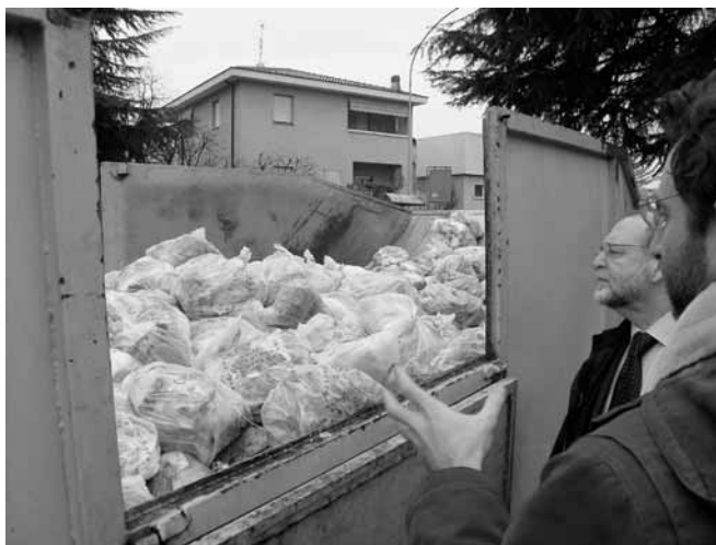
Imatge 4.6. Camió de caixa oberta per a la recollida selectiva de la matèria orgànica. Vista de detall.
